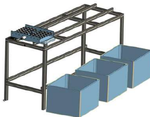
Gambar 2 Desain Perangkat Pengembalian dan Sortir Buku secara Mandiri
